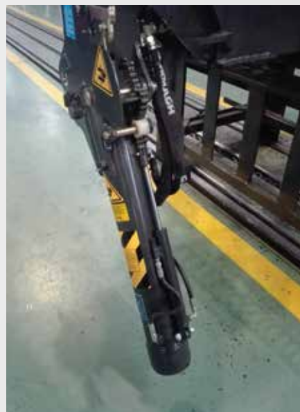
Cilindro stabilizzatore ribaltabile 180° (OPZIONE). 180 degrees tilting stabilising cylinder (OPTIONAL). Cylindre stabilisateur escamotable 180 degrés (OPTION). Stützzylinder kann 180° umgekippt werden (auf Frage).
