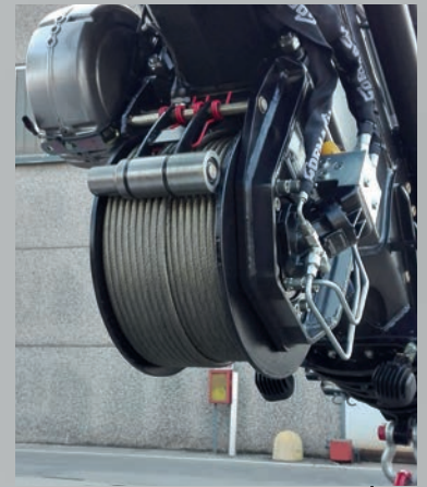
Verricello tiro diretto 2500 daN (OPZIONE). 2500 daN Winch on first line (OPTIONAL). Trebail de tir direct 2500 daN (OPTIONAL). 2500 daN Winde am ersten Seil (Auf Frage).
