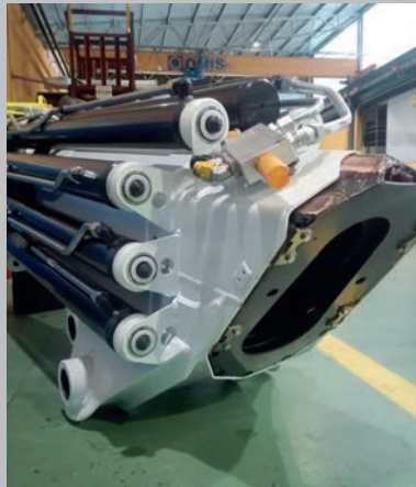
Sistema ritenzione cilindri gru chiusa. Cylinders locking system when crane is folded. Système de retenue vérin à grue fermé. Halteung System mit zusammengelegten Kran.
