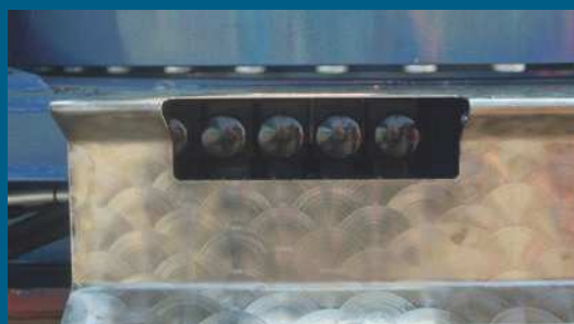
Comandi di Emergenza degli Stabilizzatori Stabilizers Emergency controls Not Bedienung der Stützen Commande d'urgence de Stabilisateurs
