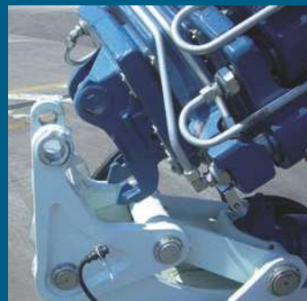
Aggancio/Sgancio rapido JIB Quick connection and disconnection of the JIB Connexion rapide de JIB Schnellkupplung des Jib (für die Hydraulik: hydraulische Schnellkupplung) Enganche/desenganche rápido del JIB
