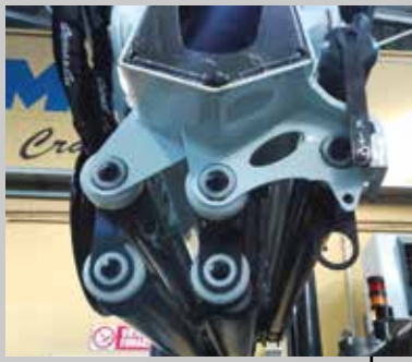
Sistema ritenzione cilindri gru chiusa. Cylinders locking system when crane is folded. Système de retenue vérin à grue ferme. Halteung System mit zusammengelegten Kran.
