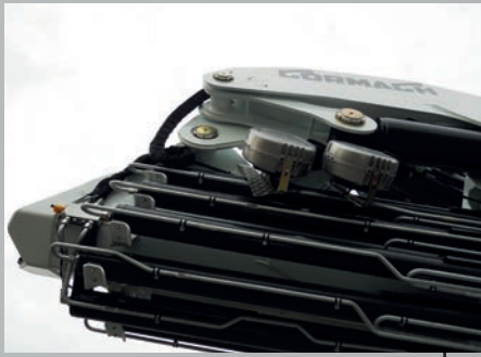
Sistema ritenzione cilindri gru chiusa. Cylinders locking system when crane is folded. Système de retenue vérin à grue ferme. Halterung System mit zusammengelegten Kran.
