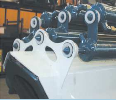
Sistema ritenzione cilindri gru chiusa. Cylinders locking system when crane is folded. Système de retenue vérin à grue fermée. Halterung System mit zusammengelegten Kran.
