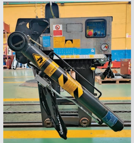
Cilindro stabilizzatore ribaltabile -50°. -50 degrees tilting stabilising cylinder (OPTIONAL). Cylindre stabilisateur escamotable -50 degrés. Stützzyylinder kann -50° umgekippt werden.
