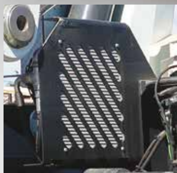
Scambiatore di calore. Heat exchanger. Refroidisseur. Ölkühler.
