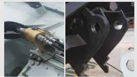
Aggancio/Sgancio rapido JIB. Quick connection and disconnection of the JIB. Connexion rapide de JIB. Schnellkupplung des JIB (für die Hydraulik: hydraulische Schnellkupplung).
